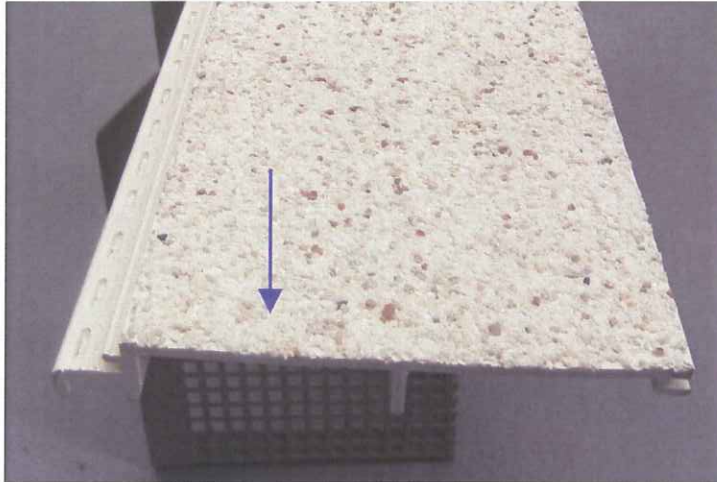
Bild 1: Auftreffposition des Fallbolzens für die Prüfung der Schlagfestigkeit
